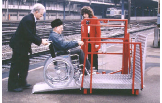
Der Rollstuhlfahrer wird durch eine Hilfsperson über die abgesenkte Rampe auf die Hubbühne geschoben.
