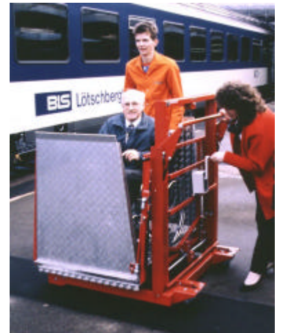
Rollstuhlfahrer mit Hilfsperson auf der Hubbühne; die Bedienperson hebt die Hubbühne an.
