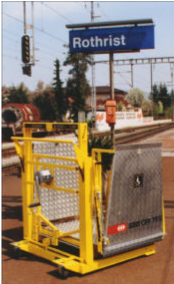
MIRO-LIFT mit leicht angehobener Hubbühne.
