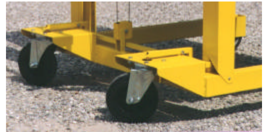
Die grösseren, steuerbaren Räder vom MIRO-LIFT Typ MA 4, mit einem Durchmesser von 200 mm, ebenfalls bremsbar.
