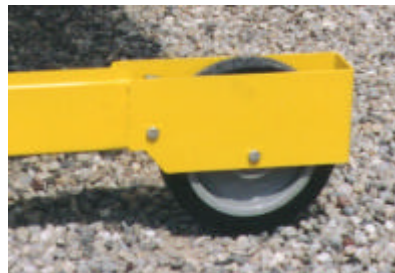
Die grösseren, vorderen Räder vom MIRO-LIFT Typ MA 4, Durchmesser 200 mm.
